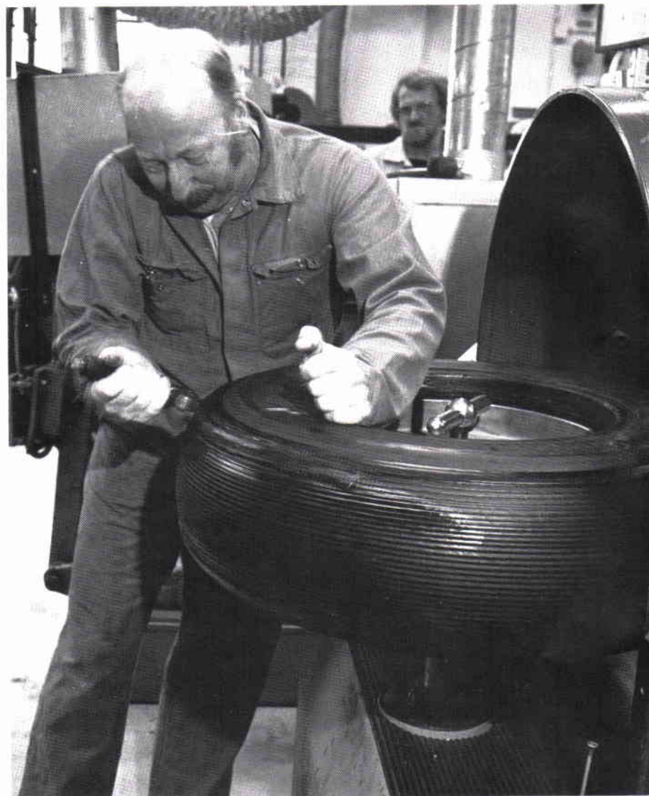
Balansering sker genom att anbringa balanseringsremсор på ovulkat gummi. På bild Roland Kroon.
