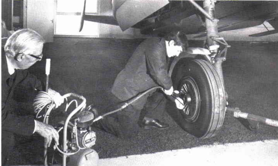
Registrator, f d flygtekniker vid F31/F13 M, Inge Arvidsson, fyller luft på "B18B-däcken". Under förflyttningen rullar planet på Caravelle-hjul men sedan pallas det upp med originalhjulen, som återfanns på en arbetsvagn i Kalmar. Förra flygverkmästaren vid F3, Martin Bengtsson assisterar.
